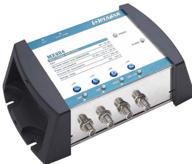
Многодиапазонный усилитель, предназначенный для усиления телевизионных сигналов в системах коллективного и индивидуального приёма телевидения. Имеет 4 входа, по каждому из которых предусмотрены: плавный аттенуатор, устройство подачи и индикации питания на дополнительные антенные усилители. Защита и индикация перегрузки внешнего питания.
