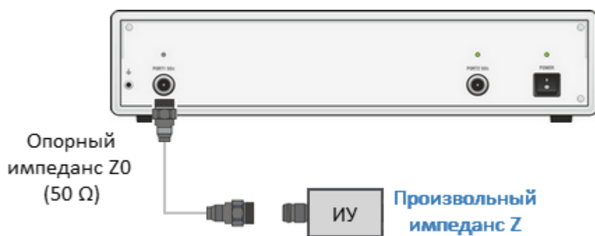
Рисунок 121 – Пример измерения анализатором с опорным импедансом 50 Ом ИУ с произвольным импедансом
