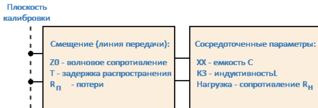
Рисунок 89 – Модель однопортовой меры
