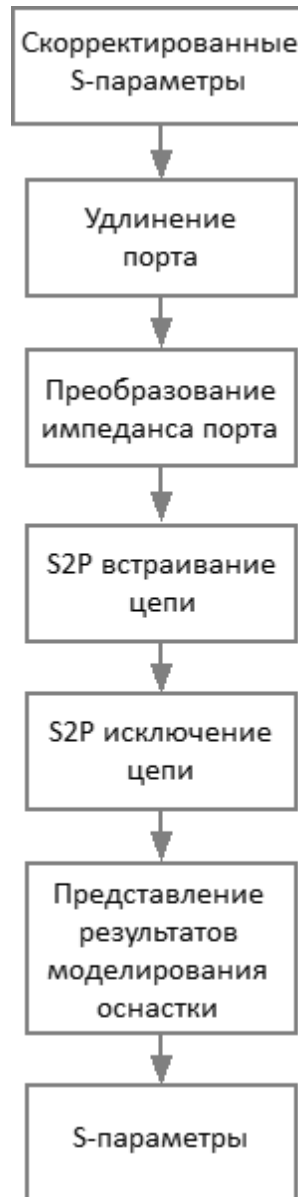
Рисунок 119 – Блок-схема обработки данных при моделировании оснастки
