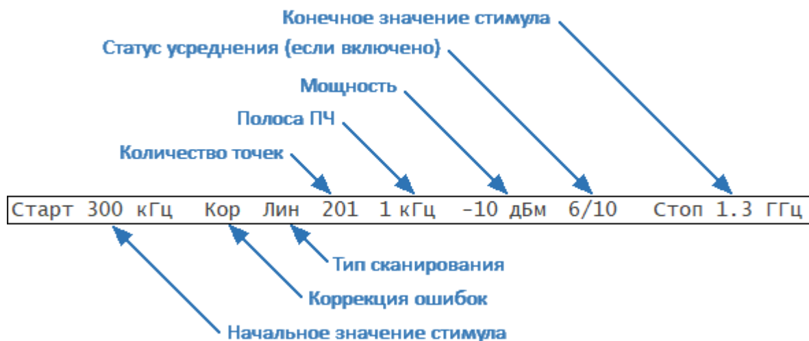
Рисунок 28 – Строка состояния канала
