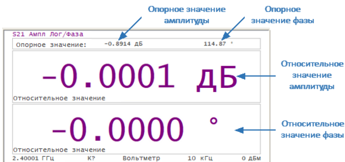
Рисунок 138 – Пример измерения относительно опорного значения
