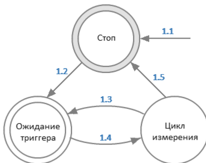
Рисунок 37 — Состояния и переходы анализатора
