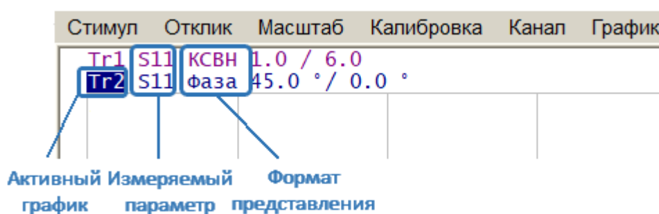
Рисунок 15 – Настраиваемые параметры в строке состояния графика
