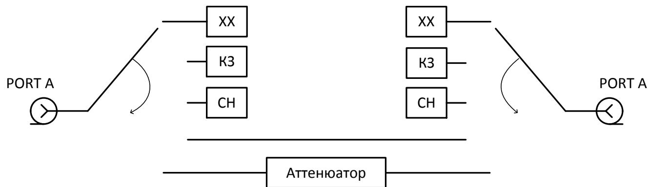
Рисунок 2.4 Функциональная схема ACM2506, ACM2509
