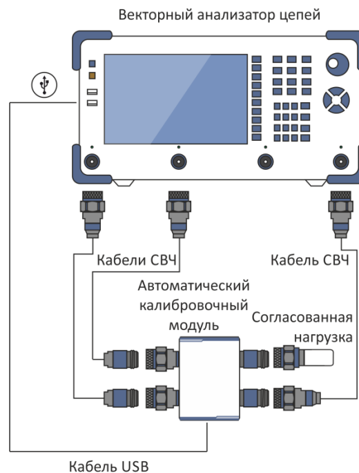
Рисунок 4.26 Схема включения модуля для выполнения полной трехпортовой калибровки на примере портов 1, 2 и 4
