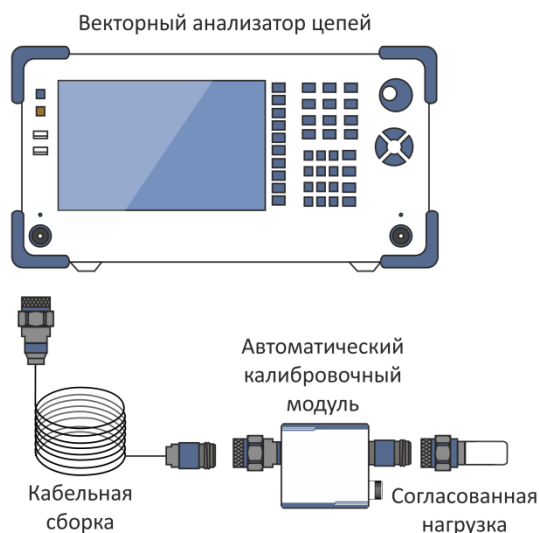
Рисунок 4.30 Схема включения модуля для измерения S-параметров длинной линии
