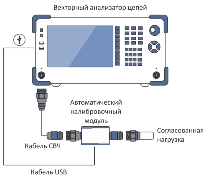
Рисунок 4.22 Схема включения модуля для выполнения полной однопортовой калибровки
